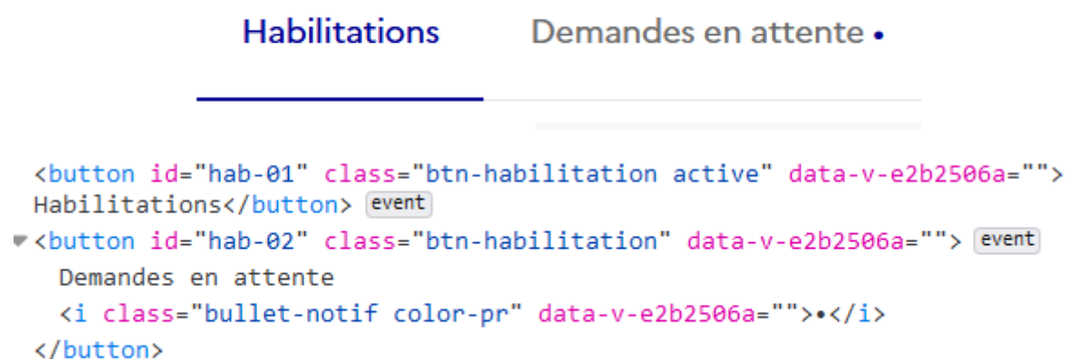
Figure 34 - système d'onglets inaccessible
